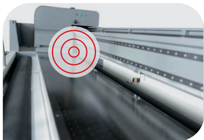
Sensore anti-crash che protegge le teste da eventuali inceppamenti
