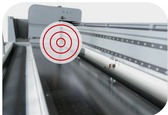
Sensore anti-crash che protegge le teste da eventuali inceppamenti
