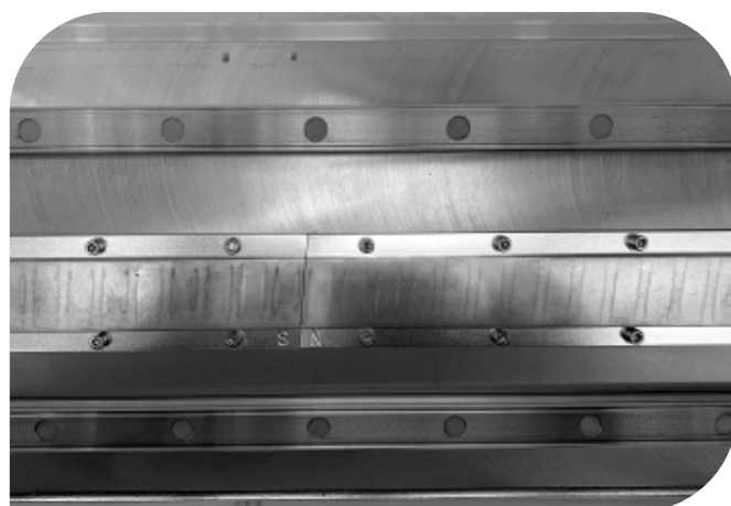
Doppia Guida lineare silenziosa ad altissima precisione
