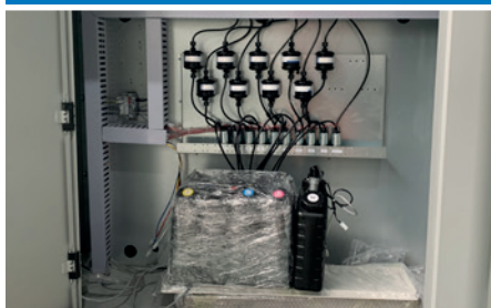
Dettaglio alimentazione inchiostri
